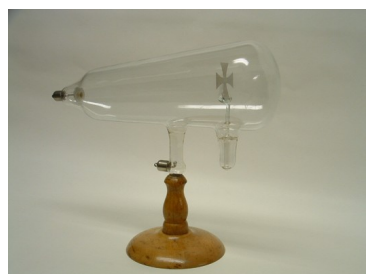
Tube de Crookes Cathode, anode, obstacle (croix de malte)
